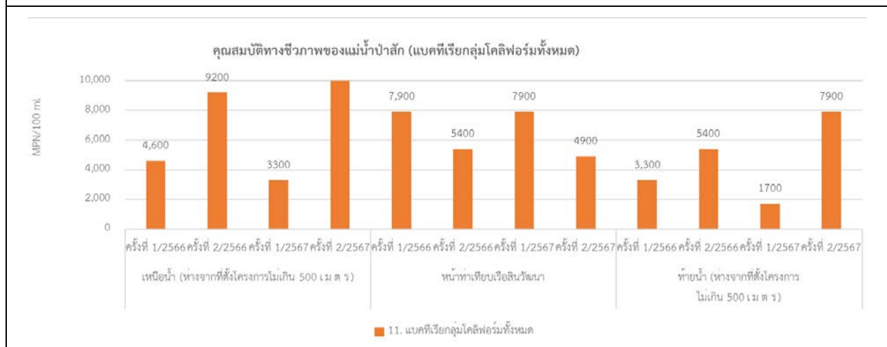
รูปที่ 3.2.3-29 การเปรียบเทียบผลการตรวจวัดแบคทีเรียกลุ่มโคลิฟอร์มทั้งหมด ในน้ำผิวดิน ในปี พ.ศ. 2566 -2567
