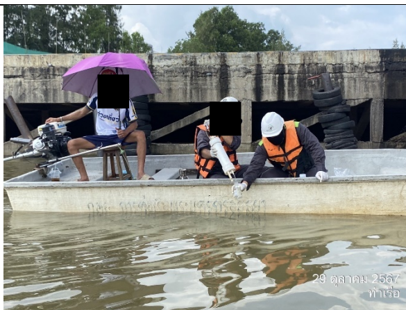
การเก็บตัวอย่างน้ำผิวดินสำหรับวิเคราะห์ดัชนีกลุ่มแบคทีเรีย
