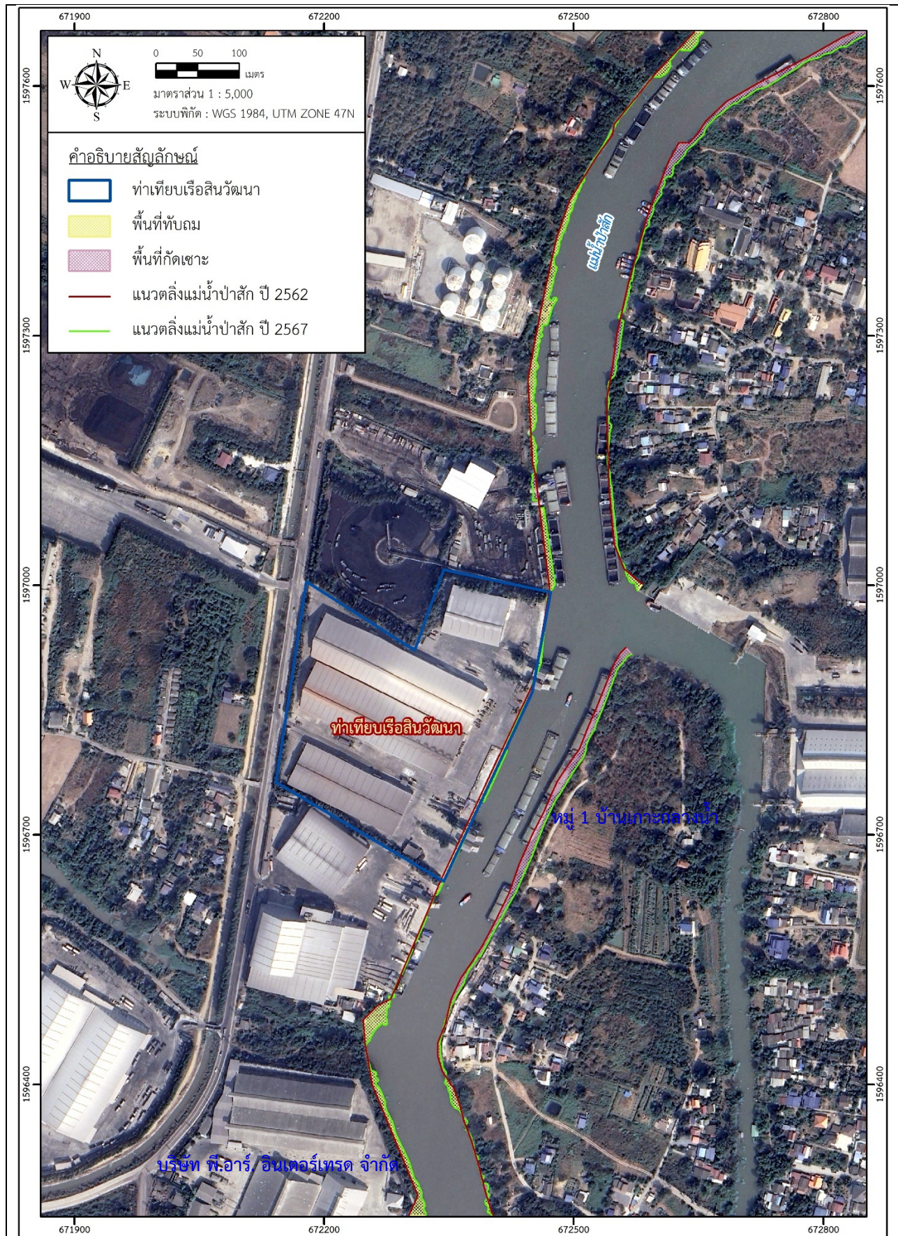
รูปที่ 3.2.4-3 ผลการวิเคราะห์การกัดเซาะและทับถมของแนวตลิ่งที่เกิดขึ้นในช่วงเวลา 4 ปี (พ.ศ. 2562-2567)
