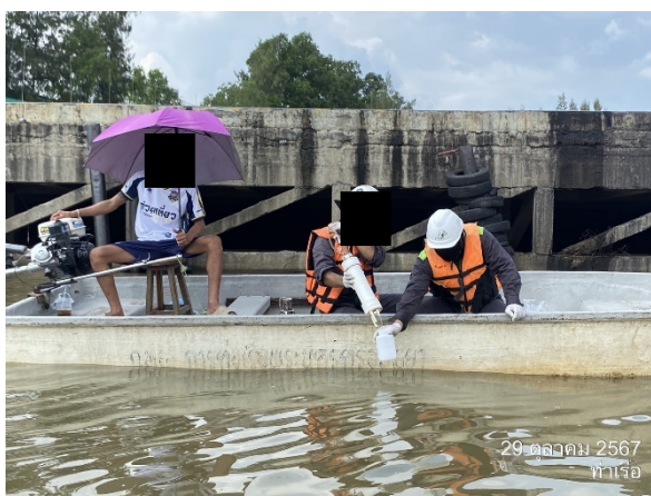
การเก็บตัวอย่างน้ำผิวดินสำหรับวิเคราะห์ BOD ด้วยเครื่องเก็บตัวอย่างน้ำแนวตั้งและขวดพลาสติก HDPE
