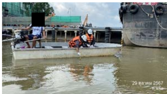
การวัดความลึกด้วยเครื่องวัดระดับความลึก HONDEX PS-7
