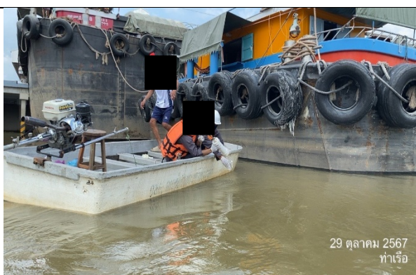
การเก็บตัวอย่างน้ำผิวดินสำหรับวิเคราะห์ DO
