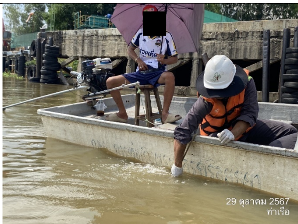
การเก็บตัวอย่างน้ำผิวดินสำหรับวิเคราะห์ DO ด้วยเครื่องเก็บตัวอย่างน้ำแนวตั้งและขวดแก้ว
